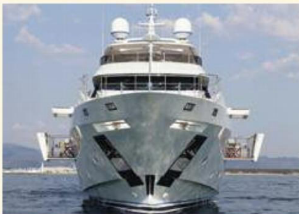
"Botti" ha scafo in vetroresina e sovrastruttura in fibra di carbonio
