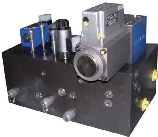
Fig. 9a – Blocco valvole progettato da CMC Marine e realizzato da Bosch Rexroth, con integrata la valvola proporzionale direzionale a 4 posizioni.
