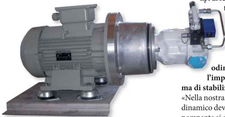
Fig. 4 – Gruppo elettropompa a portata variabile di Bosch Rexroth; motore elettrico 400 Vac 50 Hz. Cilindrata pompa 45cc; portata 65 litri/minuto a 1445 giri/minuto; pressione di stand-by 18-22 bar; pressione d'esercizio 120-140 bar. La temperatura di trafilamento della pompa deve essere inferiore a 80°C
